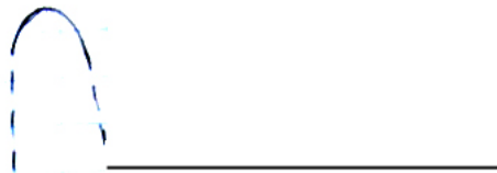
Рис. 12: Форма полученного на выходе схемы кпп-реле импульса
