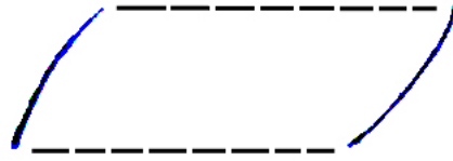
Рис. 10: Фазовый портрет мультивибратора
